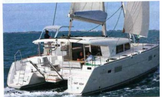
Bullige Erscheinung: Wie lebendig sich der 400 unter Segeln anfühlt, sieht man ihm nicht an. Die hochbordigen Rümpfe sind auf Volumen getrimmt. Serienmäßig: erhöhter Steuerstand und festes Bimini-Top überm Cockpit (u.)
